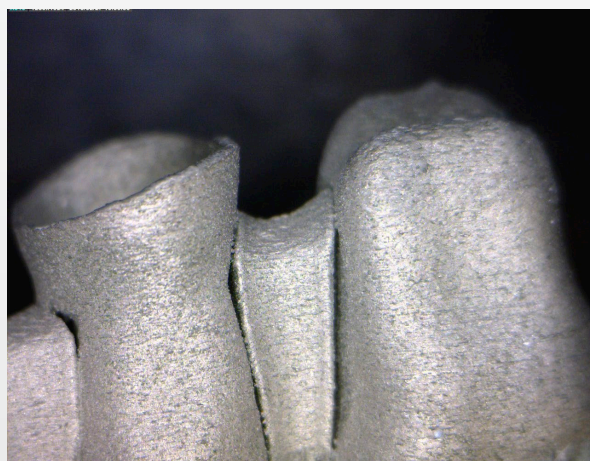
Foto 19: struttura prototipata da file, non salvata per laser melting: i punti di contatto non sono uniti alle corone. Ingrandimento con microscopio digitale
