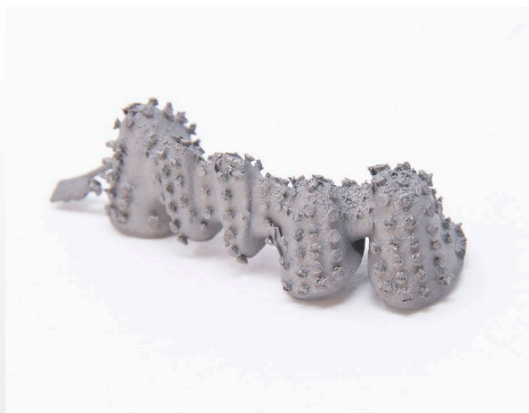
Foto 27: esempio di superficie ritentiva ottenuta tramite corretta progettazione software.
