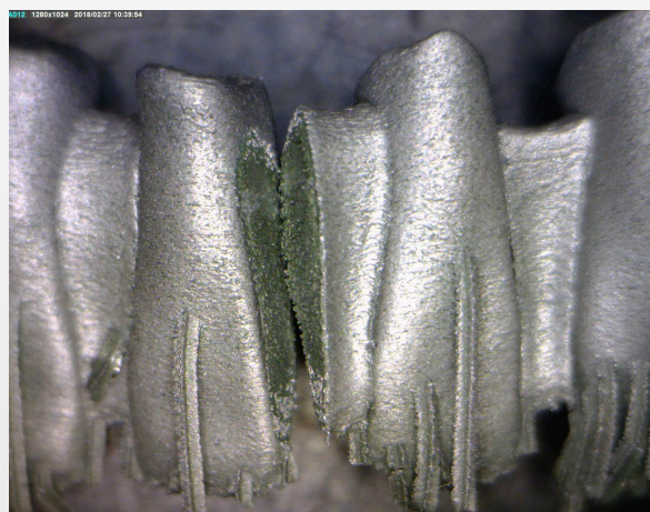
Foto 20: punti di contatto separati. L'ossidazione verde dimostra la mancata unione della mesh
