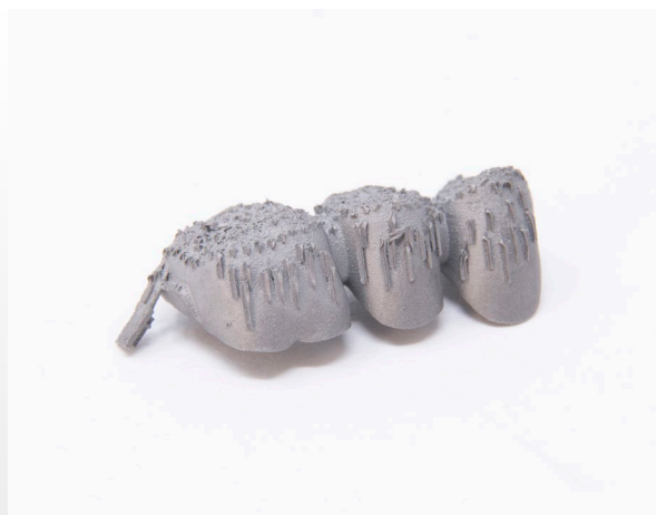
Foto 28: esempio di superficie ritentiva ottenuta tramite l'introduzione ed il post processo di opportuni pin di sostegno.
